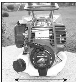
Le moteur doit être posé sur une surface plane sur son réservoir d'essence
